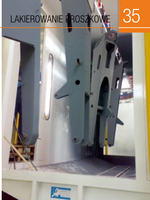
Przejście przez kabinę dielektryczną.
