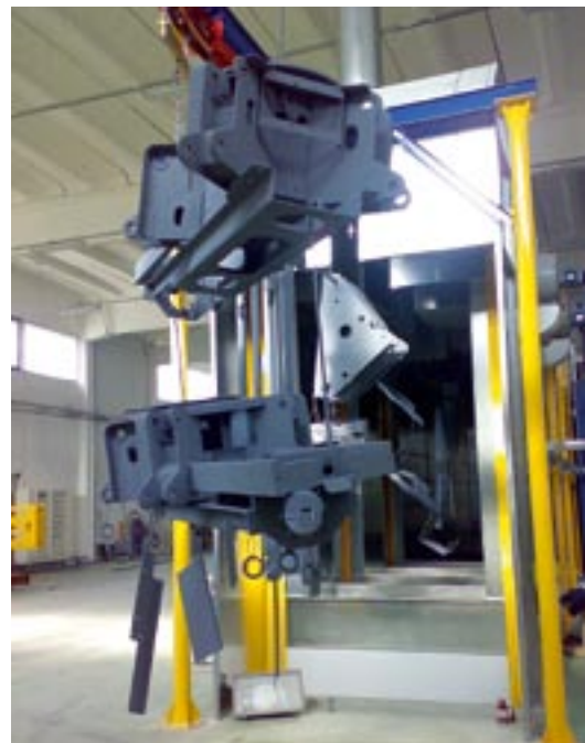
Wejście detali do pieca.
