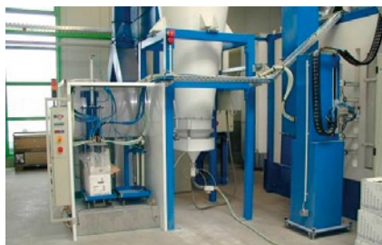
Centrum kolorów wyposażone w zasobnik z fluidyzacją.
